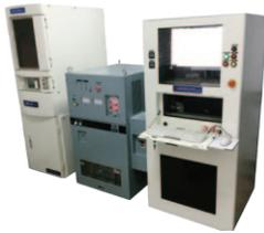
超電導コイルを利用し高保磁力磁石の磁化特性を自動測定
