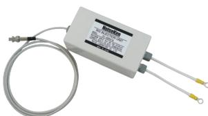
本ユニットは、当社のインパルスノイズ試験器のパルス出力を試験器内部の CDN を通さずに直接印加するためのユニットです。ボックス内部に CDN と同じカップリング用のコンデンサを内蔵しています。
