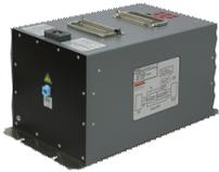
本器は、IEC 61000-4-5 規格に規定されている 1000Mbit/s までの非シールド・対称高速通信線にサージ試験を行うことができます。
