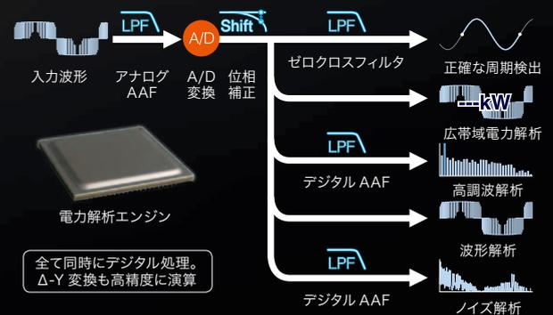
\* AAF (アンチエイリアシングフィルタ) : サンプルング時に発生する折り返し誤差を防止するフィルタ
