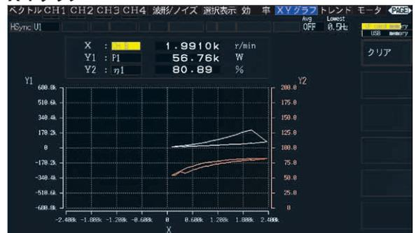
インパタの特性評価やモータのトルクマップの作成に。任意の項目を選択し、X-Y プロットグラフを表示します
