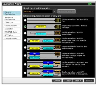
ベストな測定に必要となる最適な設定条件を、セットアップウィザードでステップごとに教えてくれます。このイコライゼーションのウィザードでは、接続時のフィクスチャ、ケーブル、プローブなどの影響を独自の手法で除去できるので、高速なデータ信号のつぶれたアイパターンでもしっかり開いたアイとして解析可能です。
