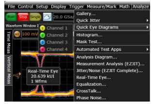
Infiniiumの GUIは、マウスやタッチ操作のために最適化されたシンプルでわかりやすいメニュー構造になっており、誰でも簡単にアクセスできます。ジッタ測定、アイダイアグラムなどは、解析メニューをワンクリックするだけで、自動的にセットアップします。
