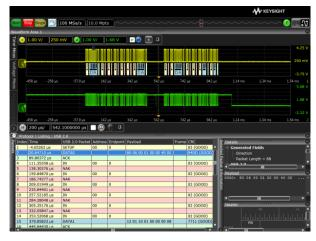
各種シリアル通信規格のデコード/トリガ機能は、信号 波形と連動したデコード表示や、エラー条件などのプロ トコルレベルでのトリガ設定が可能です。
