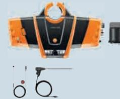
testo 330i O<sub>2</sub>、H<sub>2</sub> 補償付COセンサ搭載セット
