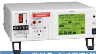
製品名：漏れ電流試験器 ST5541
