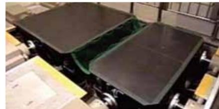
3軸同時加振に回転を加えた6自由度加振が可能。シートの乗り心地などを客観的に評価。
