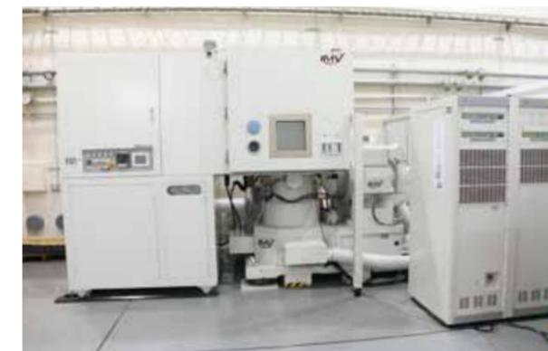
多軸システムに恒温恒湿槽を付属した複合3軸同時システム軸受方式にICCUを採用。温湿度環境に3軸の振動を同時に加えることにより、実環境に即した試験が可能。一般電子部品等の評価用に利用。
