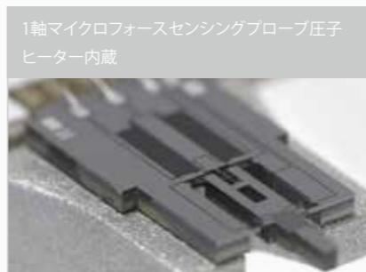
FT-I04フェムトインデンターは、マイクロ・エレクトロ・メカニカル・システムズ（MEMS）技術に基づく高分解能ナノインデンターです。従来のナノインデンテーション装置が精密加工・組立部品に基づく荷重検出技術を採用する一方、フェムトツールズは半導体製造技術を用い、単結晶シリコンウエハーから荷重センサー全体を加工しています。このアプローチにより、従来技術では達成困難な高感度・高分解能・高再現性を備えたロードセルを実現する微小構造の製造が可能となります。さらに、MEMS検知素子の小型化により、従来型ロードセルと比較して質量が桁違いに低減。シリコンフレクシャーの高い剛性と相まって、FemtoTools FT-Sマイクロフォースセンシングプローブは高い固有振動数（最大50kHz）を実現。これにより高速現象の計測や、高周波数での疲労試験・繰返し試験の実施が可能となります。
