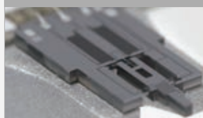
チップヒーターを内蔵した1軸マイクロフォースセンシングプローブ
