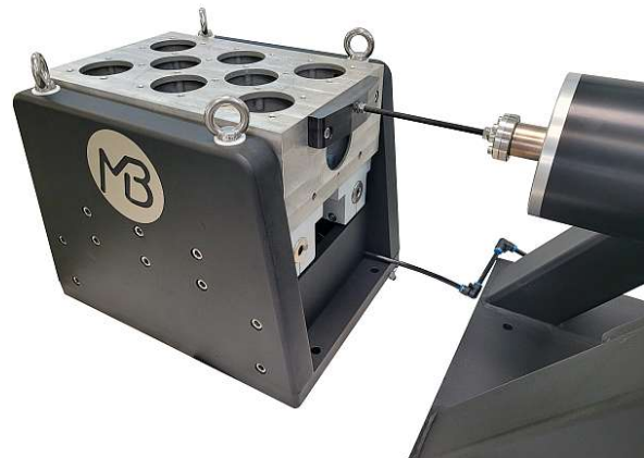
図 9: ALPHA 加振器用水平移動テーブル
