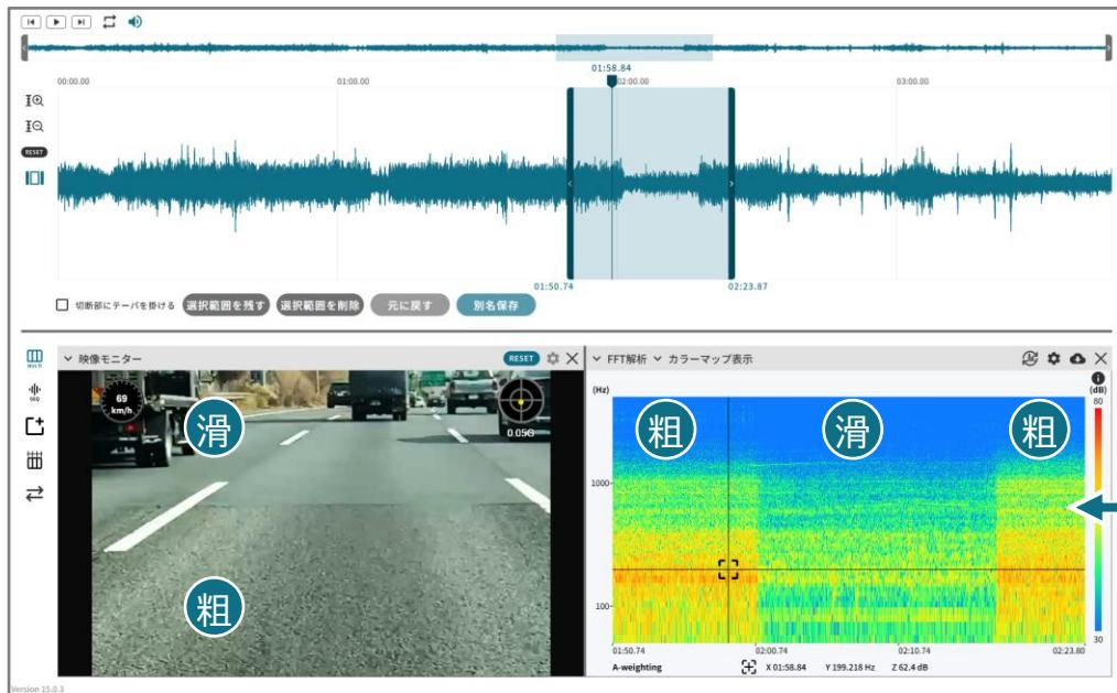
路面が変わると、音が変わる。Sound Oneなら、映像と周波数が同期して「音の違い」を証明。広帯域ノイズの増減を一枚で可視化し、舗装・タイヤ・足回り・吸音材等の評価を一画面で一気通貫に進められます。
