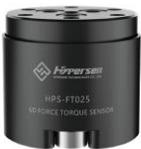
**HPS-FT025** 6次元力センサは、重量がわずか28グラム、製品サイズが23×26.2mm(直径)で、合金鋼と航空アルミニウム材料で作られており、最大データ転送周波数は2000Hz、IP65防水で、350%の過負荷に耐えることができます。
