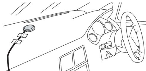
GPSアンテナ設置イメージ (車室内ダッシュボード上)
