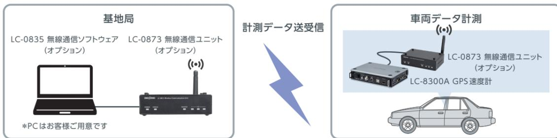
LC-0873無線通信ユニットを介して、LC-8300A本体と基地局PCとの間でデータを相互にやりとりします。通信距離は約100m\*。最大63台のユニット間での無線通信が可能です。
