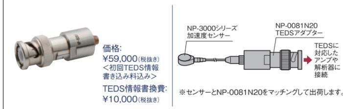
本器は、TEDS非対応のプリアンプ内蔵型加速度センサーにTEDS機能を付加するアダプターです。本器に使用する加速度センサーの感度情報などを書き込み、加速度センサーとTEDS対応計測器の間に挿入することで、TEDSセンサーの機能を使用することができます。
