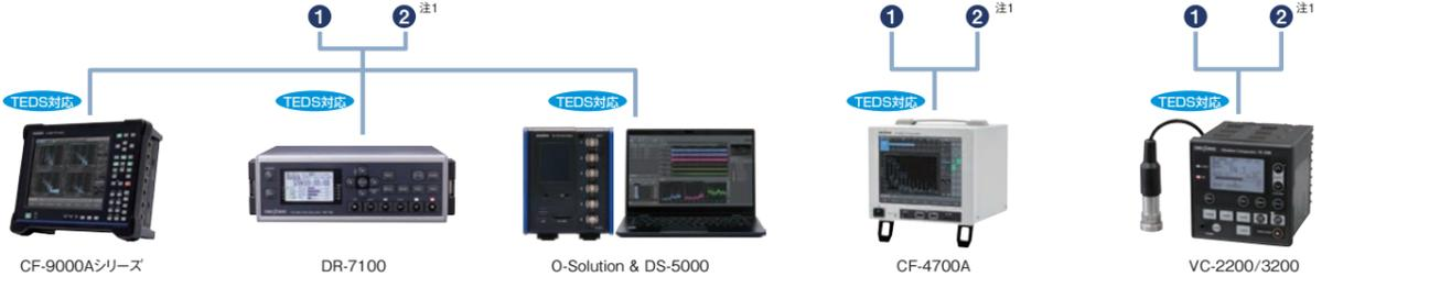
①: 電圧入力(BNC(C02型)コネクタ) ②: センサー入力(BNC(C02型)コネクタ)<sup>注1</sup>
