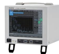
製品の音や振動による精密な品質検査に最適なライン判定機です。当社が長年培ってきたFFTによる周波数解析技術を搭載することで、問題となる特徴的な周波数成分を抽出し、良否判定を行います。周波数成分の大きさや波形の形状での判定機能、周期的に変動する音や振動の変動量を抽出して、その変動量で判定することができる変動成分抽出機能を搭載しました。ベアリングの振動監視や、モニター機能(ヘッドホン出力)による振動の可聴化による聴感的な確認も可能です。
