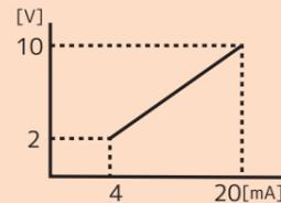
4~20mAを電圧に変換する場合の抵抗値は、2~10Vに変換する場合500Ωが使用されます。消費電力は最大で0.2W (=10Vx20mA)ですから、定格は1/4W(0.25W)以上、変換精度を上げるため、一般的には±0.1%を選定します。
