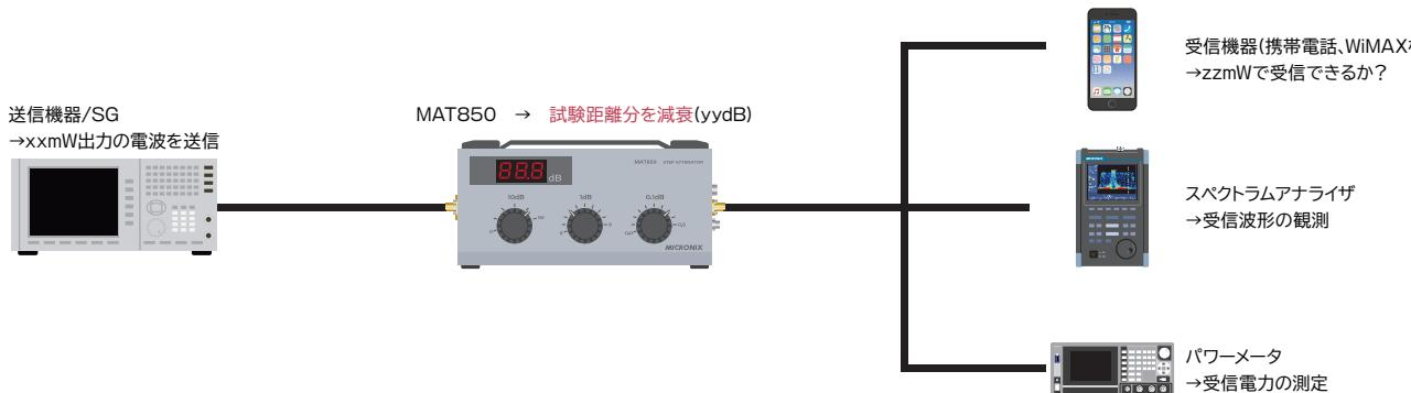
有線接続での試験環境しか持たない場合も、MAT850を使用し送信機出力を減衰させる事で、各種無線(携帯電話、WiMAXなど)の通信試験のシミュレーションができます。
