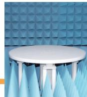
電動ターンテーブル:DUTを回転させ、アンテナパターンを測定します。
