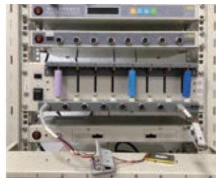
図3: バッテリー治具とテスターの接続
