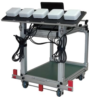
DSRCアンテナME9301から発射される電波の強さ(電界強度)を測定する機器です。
