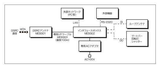
ME9300システムは、DSRCアンテナME9301とインタフェースボックスME9302及び専用I/FケーブルME9303とから構成されています。
