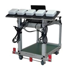
DSRCアンテナME9301から発射される電波の強さ(電界強度)を測定する機器です。
