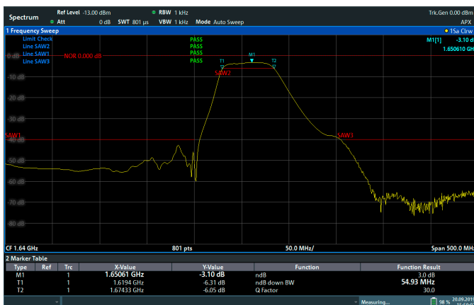
SAWフィルターの測定と品質保証 (n-dBダウン帯域幅、Q値)
