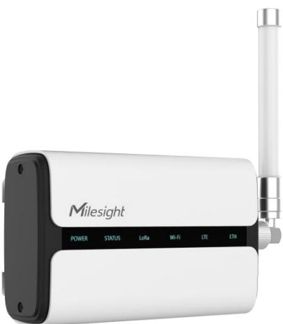
UG65 は、堅牢な 8 チャンネル屋内用 LoRaWAN® ゲートウェイです。SX1302 LoRa チップと高性能クアッドコア CPU を採用し、UG65 は 2000 以上のノードとの接続をサポートします。UG65 は最大 15km の見通しを持ち、市街地では約 2km をカバーすることができるため、スマートオフィス、スマートビル、その他多くの屋内アプリケーションに最適です。
