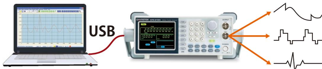
任意波形機能は、最高サンプリングレート20MS/s、垂直分解能10ビットおよび波形メモリ4Kポイントで、前面パネルのキーパッドによりポイント毎に波形データを作成できます。また、任意波形編集ソフトウェアを使用してPC上で波形を作成しUSBインターフェース経由で、波形データをAFGへダウンロードすることができます。
