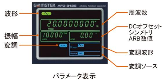
3.5インチカラー液晶により、出力波形の周波数、振幅、DCオフセットやその他のパラメータ設定が同時に表示され見やすく簡単にチェックできます。
