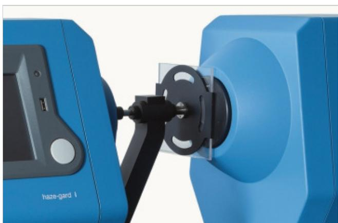
透明材料の摩耗性評価用ホルダー
