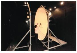
国内でも最大級の直径3メートルの積分球です。 スポーツ施設向けの大型照明器具などの全光束計測が可能です。
