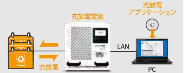
再生型直流電源pCUBEと充放電アプリケーションをインストールしたお持ちのPCをLAN接続すれば、pCUBEをプログラム動作可能な充放電電源として、ご活用いただけます。電源単体で
