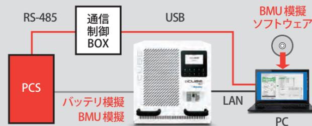
作できます。蓄電システム用インバータは、BMU との連動が必要不可欠です。連動機能により、実バッテリー、BMU がなくてもトータルシステムとしての連動性評価が可能となります。
