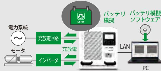
再生型直流電源pCUBEとバッテリー模擬ソフトウェアをインストールしたお持ちのPCをLAN接続することで、pCUBEを模擬バッテリーとして動作させることができます。実際のバッテリー特性を模擬するだけでなく、リアルタイムに現状のIV特性と動作
