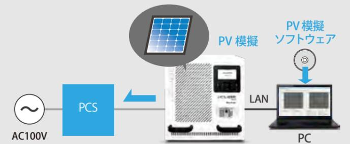
再生型直流電源pCUBEとPV(太陽電池)模擬ソフトウェアをインストールしたお持ちのPCをLAN接続することで、pCUBEを太陽電池パネルとして動作させることができます。実際のIV特性を模擬するだけでなく、リアルタイムに現状のIV特性、動作
