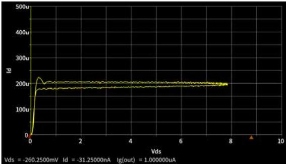
振幅・時間を調整し、任意のゲートパターン入力が可能です。また、ゲートへの予備信号印加も可能です。ヒステリシスを持ったデバイスを複数の条件で測定することが可能です。
