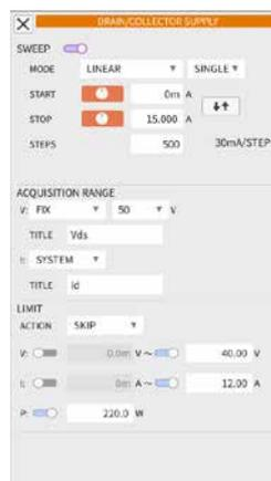
電圧・電流・電力、それぞれのリミット値を設定でき、DUTの損傷を防ぐことができます。
