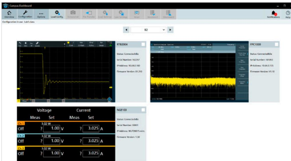
R&S®CDS キャンパス・ダッシュボード・ソフトウェアを使用すれば、コンピューター上ですべての測定器を1つのベンチに表示できます。ソフトウェアは、各測定器のリモート制御もサポートしています。
